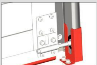
Sabot anti-effraction Sécurise le galet inférieur Fixé sur le rail vertical et au sol
