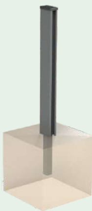
POTEAU ALU À SCELLER SUR FER 30x30 HAUTEUR MAXI CONSEILLÉE 1800mm
