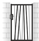
Version n.° 3 BARREAUDAGE NON DEBORDANT ET ENTRE TRAVERSES
